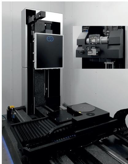
**Bild 2.** Dieses Koordinatenmessgerät mit Computertomografie verfügt über einen Hochleistungsdetektor mit 4000 × 4000 Bildpunkten (links) und eine Zwei-Röntgenquellen-Anordnung bestehend aus einer Hochleistungs-Makrofokus-Röntgenröhre (rechts oben) und einer hochauflösenden Mikrofokus-Röntgenröhre (rechts unten).
